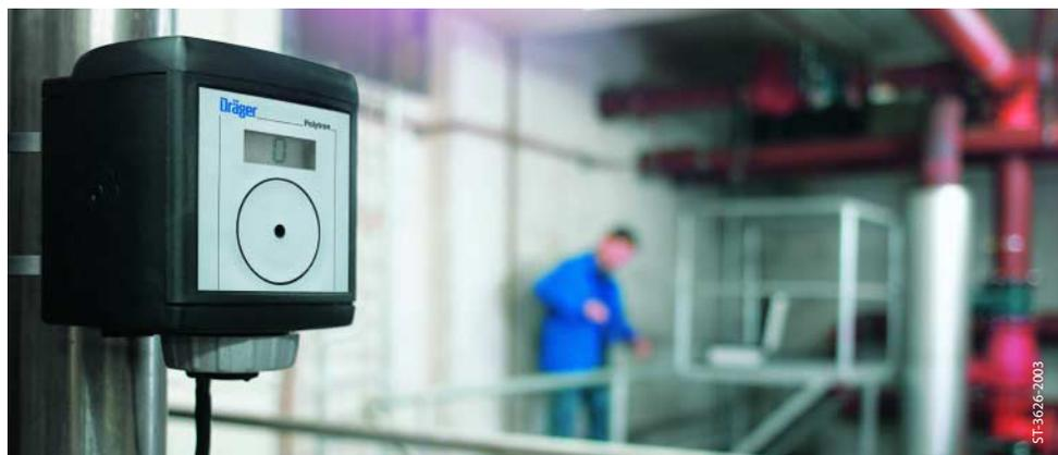
Dräger Polytron 3000 - новая измерительная головка для контроля содержания токсичных газов и кислорода в воздухе рабочей зоны. Она принадлежит новой генерации газовых детекторов, основанных на модульной платформе. Измерительная головка передает сигнал на контрольный блок через аналоговый выход 4-20мА. Выпускается более 60 версий Dräger Polytron 3000 на различные газы и различными диапазонами в комплектации с дисплеем или без дисплея.
